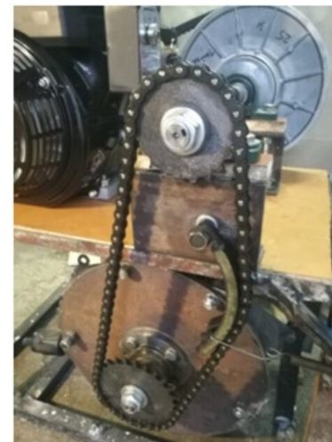
Для оценки принятых по конструкции силовой передачи решений, отработки регулировок механизмов был изготовлен стенд. Март 2023
